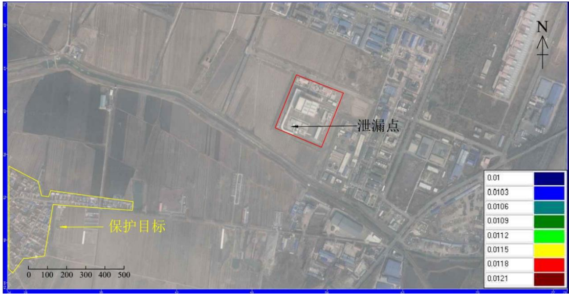
图 5.3-32 渗漏 1000 天污染影响范围（砷）
