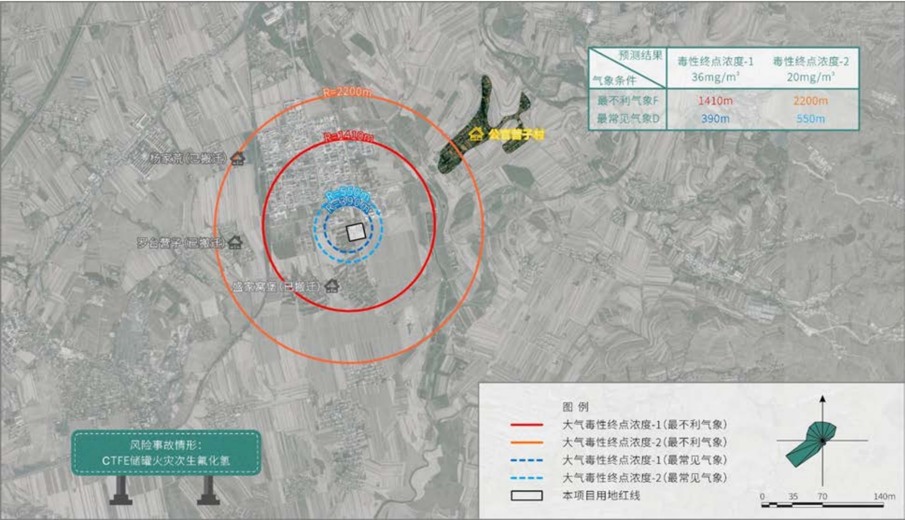
图 7.5-9 CTFE 储罐火灾次生氰化氢事故最大影响范围
