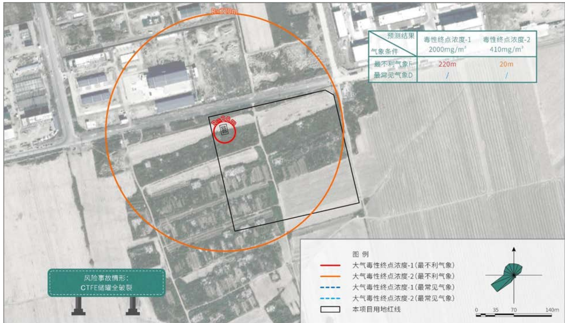
图 7.5-7 CTFE 储罐全破裂事故最大影响范围
