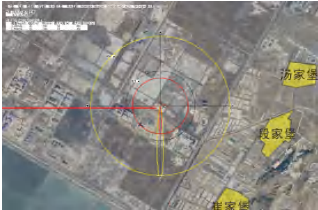
图 7.14 D 类稳定度下 HCl 轴线最大浓度超过给定阈值的最大廓线图
