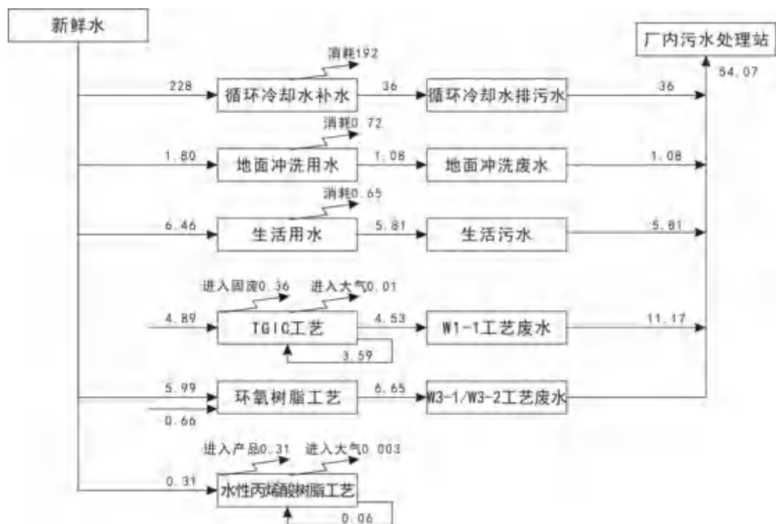
图 3.14 项目全部建设内容水平衡表（冬季）（单位：t/d）
