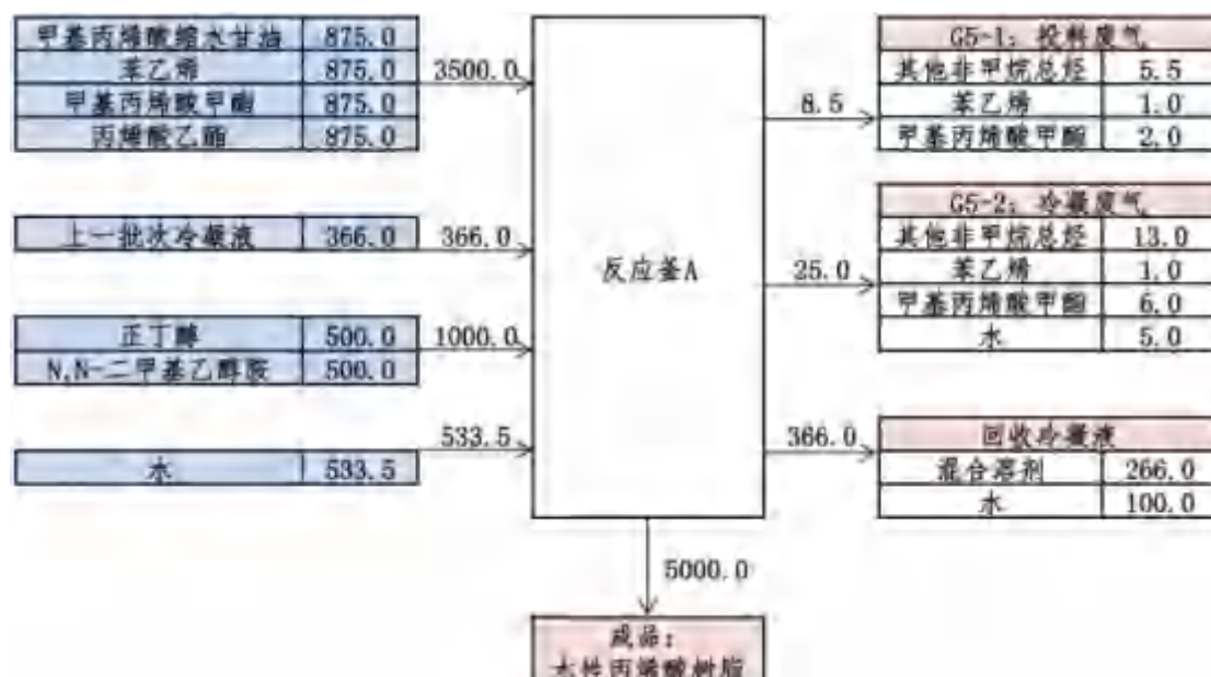
图 3.12 项目水性丙烯酸树脂产品的批次物料平衡图 (kg/批次)
