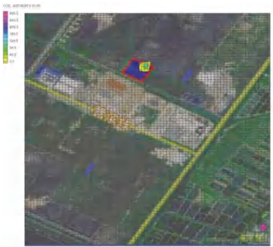
图 5.32 生化废水瞬时渗漏 10 年污染晕扩散图
