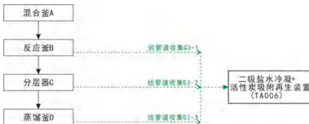
图 6.4 生产环氧树脂产污节点及处理流程
