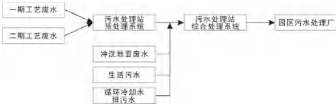
图 5.23 项目废水处理流程示意图
