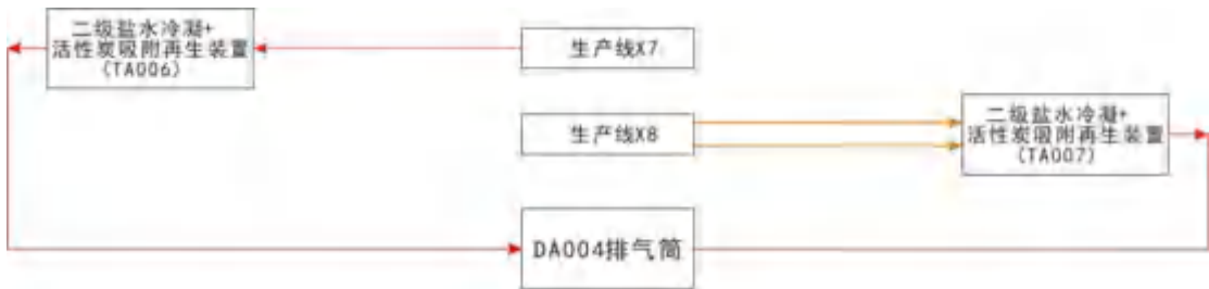
图 6.6 项目 6 条生产线的废气治理流程
