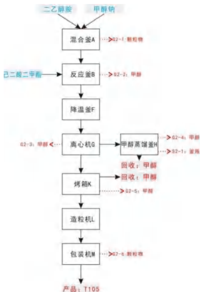
图 3.5 产品 T105 固化剂工艺流程及产污节点图
