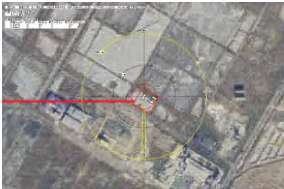
图 7.27 F 类稳定度下 CO 轴线最大浓度超过给定阈值的最大廓线图
