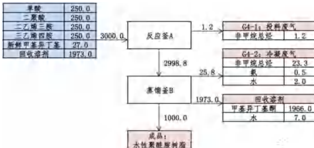
图 3.10 项目水性聚酰胺树脂产品的批次物料平衡图 (kg/批次)
