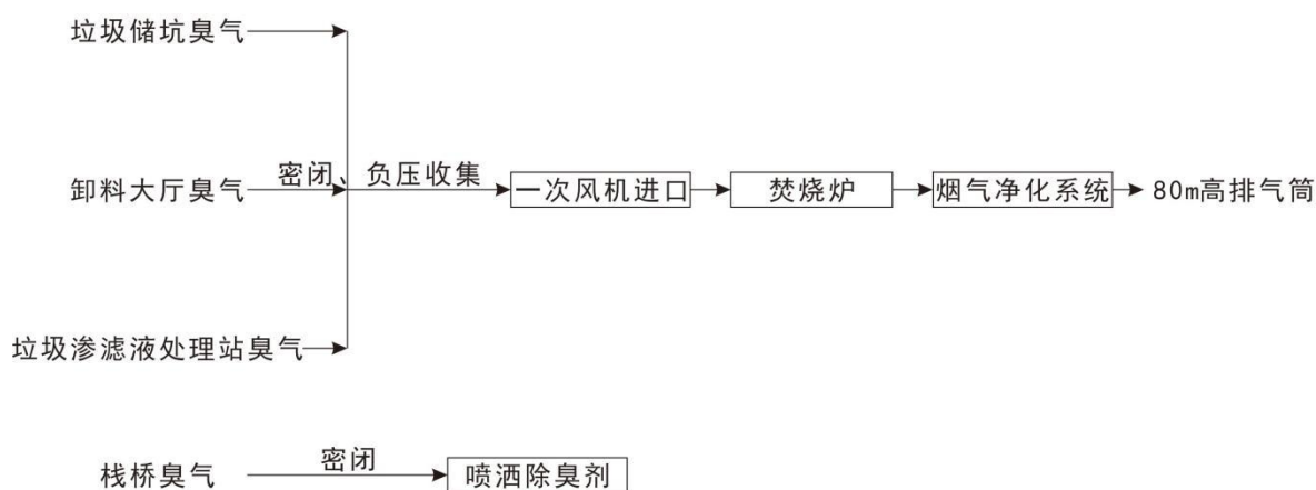
图 4.3 正常工况下恶臭气体控制流程
