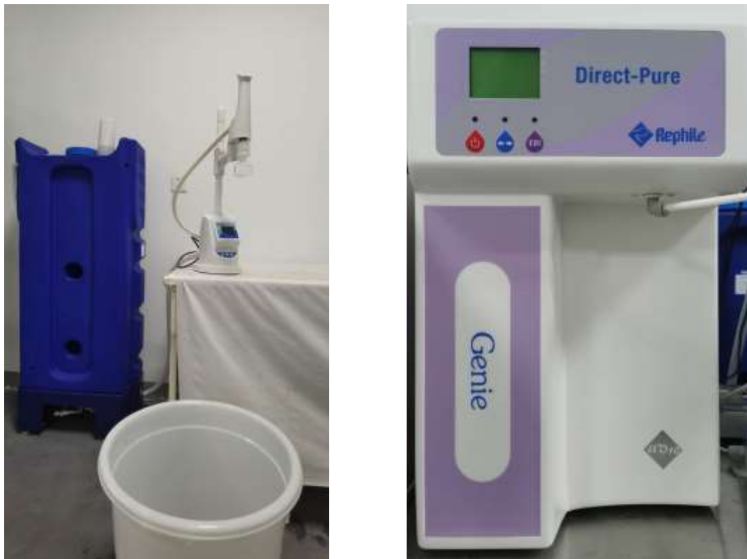
本项目纯水制备装置
