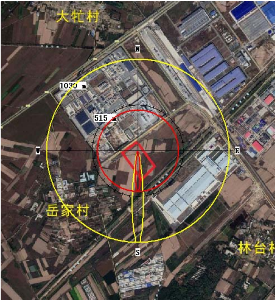
图7.6-4 D稳定度下甲苯储罐火灾、爆炸次生污染物CO超过给定阈值的最大廓线
